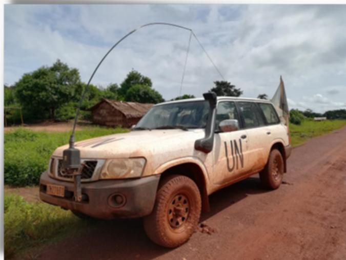
Figura 5 – antena para rádio HF de 3m de comprimento no veículo empregado por observadores militares na MINUSCA
